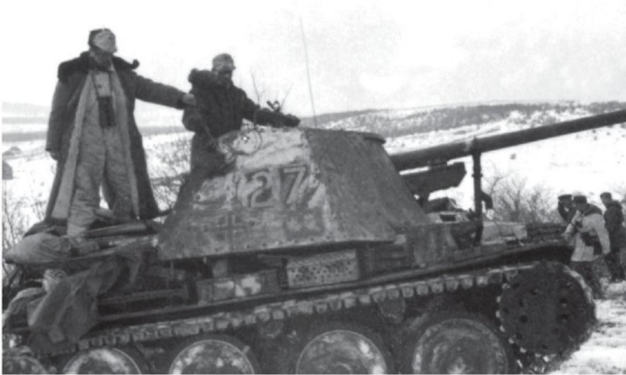
▲ Gros plan sur le Sd.Kfz. 138 Ausf. H Marder III n° 27 de la SS-Panzerjäger-Abteilung « LSSAH ». Malgré leur casemate ouverte, ces engins ont été utilisés dans les combats urbains pour Kharkov. US Nara
